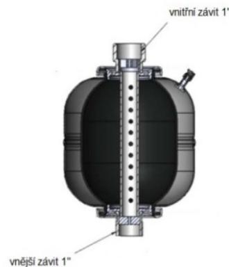
Průtočná tlaková nádoba je vhodná zejména pro použití v kombinaci s čerpadlem ovládaným elektronickou řídící jednotkou nebo s čerpadlem vybaveným frekvenčním měničem.
